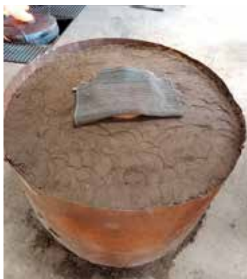
V obalu se skrývá forma na zvon. V případě velkých zvonů se formy vkládají do zvonařské jámy.
